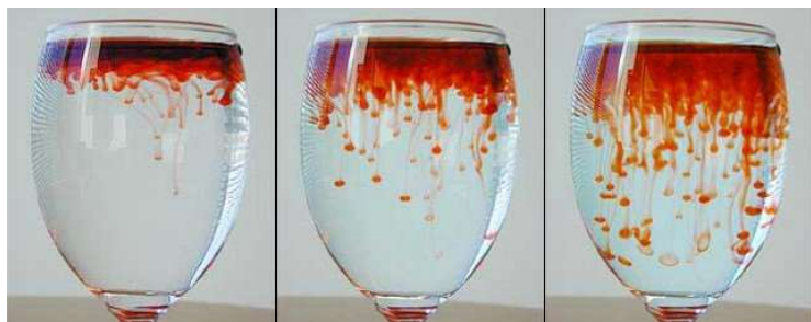
写真 1 : ワイングラスの水の表面に重い赤ワインをゆっくり注ぐと乱流状に混ざり合おうとする。これが自然の摂理。この赤ワインを水平に横一列に下げていこうという手品がレーザー核融合の原理。
