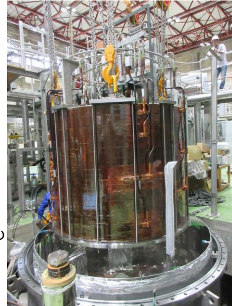
JT60SA CSモジュール (実機：重量18tのコイル)
