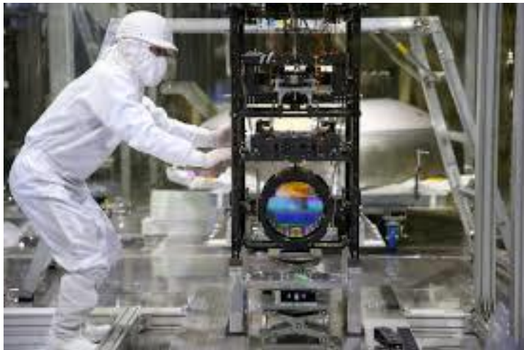
KAGRAの極低温サファイア鏡懸架系
