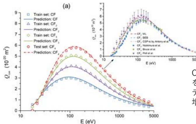
CF<sub>x</sub>分子に対し、原子物理計算と経験則を組み合わせた電離断面積計算を教師データとして、CFから順にF原子数を増やした分子の電離断面積を推定 (Zhong 2019)
