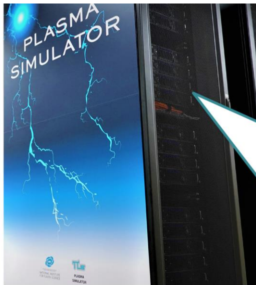
大規模並列型計算サーバ SX-Aurora TSUBASA x 540 4320VE(34,560 core)
