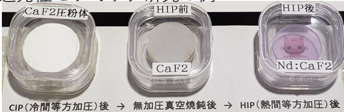
CIP(冷間等方加圧)後 → 無加圧真空焼鈍後 → HIP(熱間等方加圧)後
