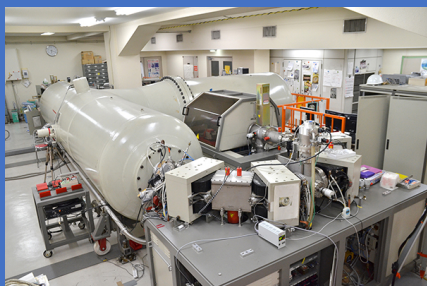
名古屋大学 宇宙地球環境研究所 (加速電圧: 2.5 MV, 電流: 20~30 \mu A)
